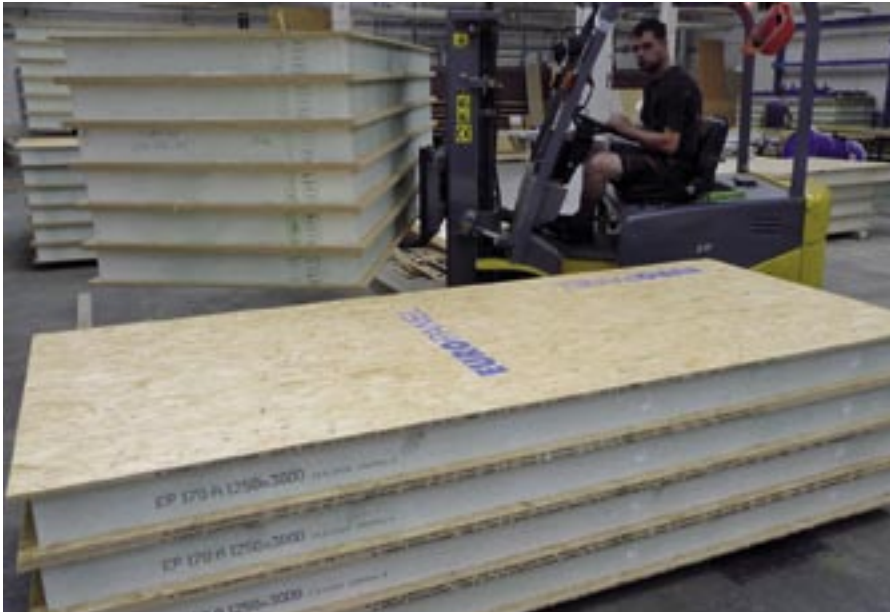
Panely SIPs vo výrobnom závode
